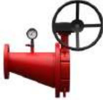
Kit aspirazione (vers. sottobattente) DN 65/125 da installare sul lato aspirante delle pompe principali per rispettare i requisiti della norma: "diametro minimo tubazione 65 mm, velocità massima dell'acqua nelle tubazioni di aspirazione 1,5 m/s alla portata di progetto". UNI EN 10.6.2.1.
