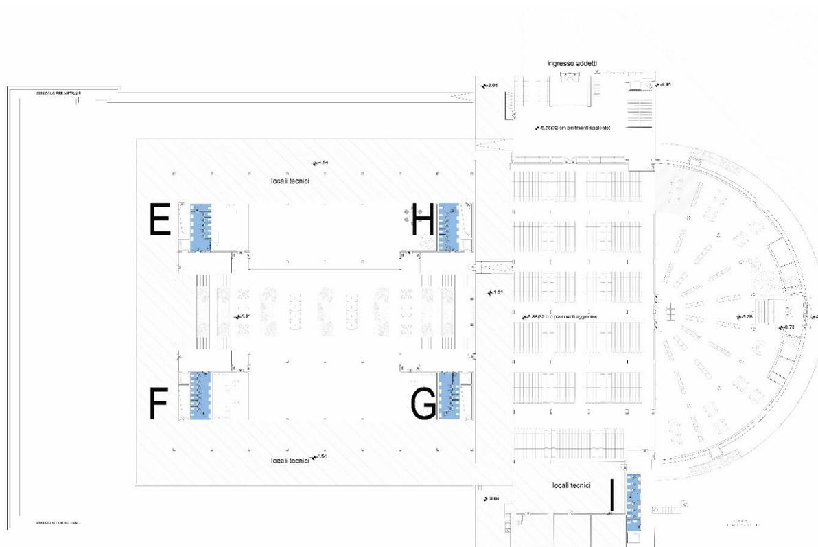
Figura 12 Piano Interrato - blocchi WC in progetto
