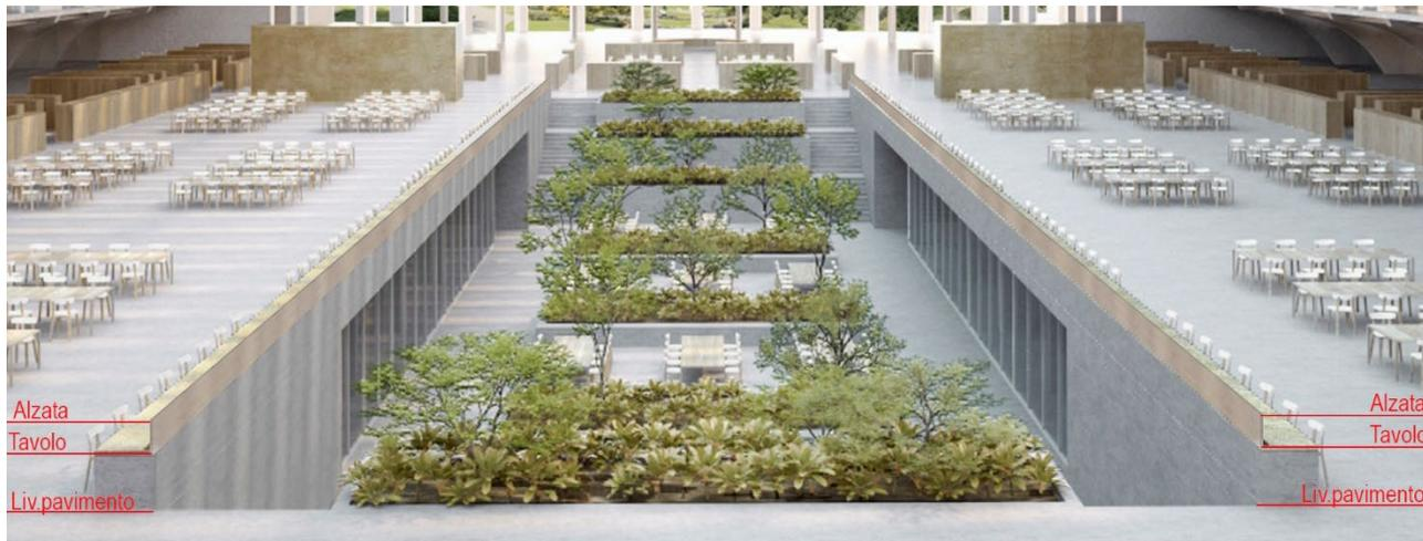
Figura 10 Schema della soluzione adottata in corrispondenza dell’affaccio sulla piazza ipogea, con la configurazione delle postazioni di lavoro continue che fungono da parapetto anticaduta.
