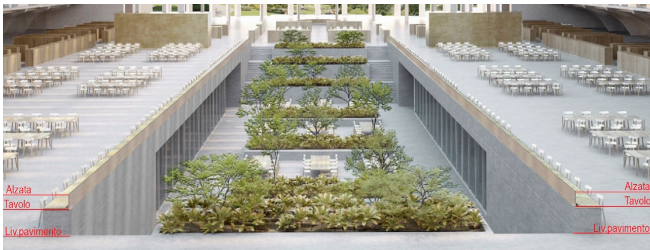
Schema della soluzione adottata in corrispondenza dell'affaccio sulla piazza ipogea, con la configurazione delle postazioni di lavoro continue che fungono da parapetto anticaduta.
