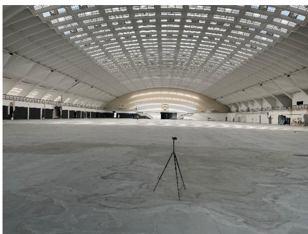
Figura 10– Stato di fatto. Misurazione del tempo di riverberazione.
