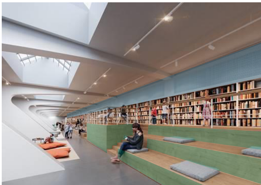
Figura 35 – Immagine renderizzata dell’area delle balconate con indicazione della posizione del trattamento acustico a parete (in azzurro) e in corrispondenza dell’alzata delle gradonate in legno (in verde).
