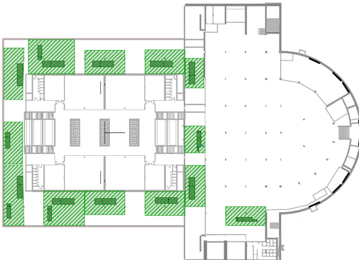
Figura 51 – Schema del trattamento fonoassorbente (in verde) da prevedere a soffitto del locale tecnico al piano interrato.
