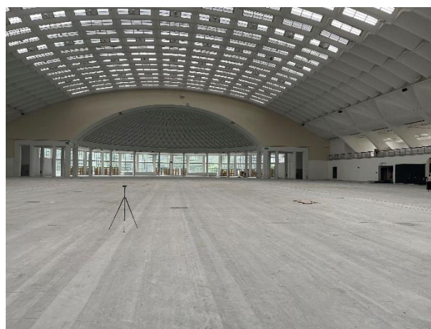
Figura 10– Stato di fatto. Misurazione del tempo di riverberazione.
