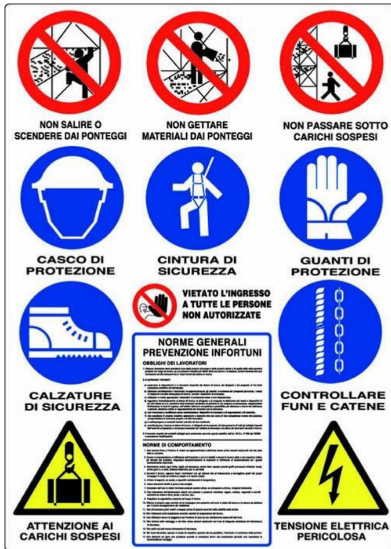
Figura 23 - Segnaletica di cantiere
