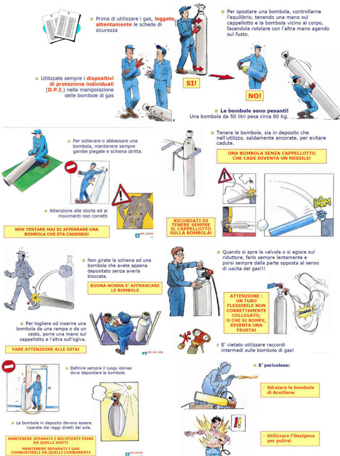
Figura 22 - Scheda per la corretta manipolazione delle bombole
