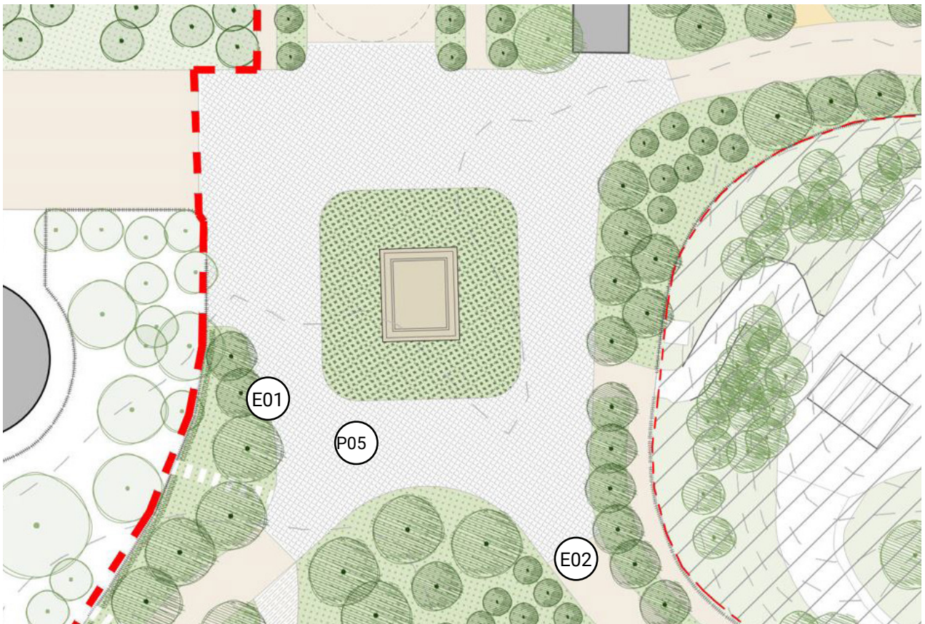
P05 - Pavimentazione in cubetti di diorite chiara piemontese.
