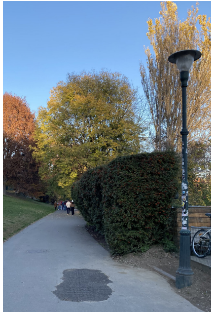
Palo in ghisa piccolo, apparecchio riflettore con coppa prismaticizzata
