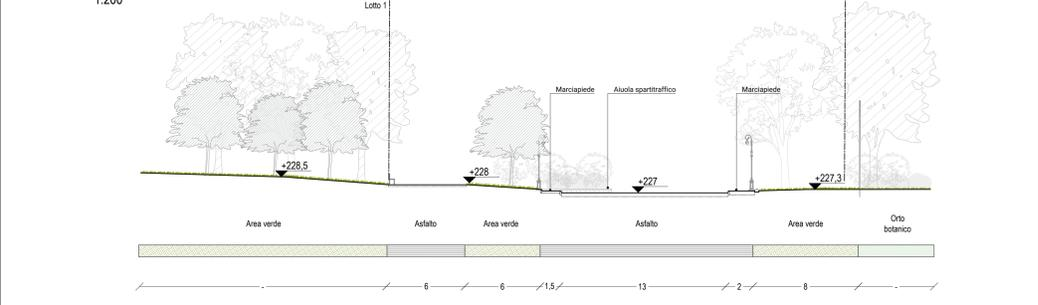
SEZIONE L-L' - STATO DI PROGETTO - VIALE MATTIOLI
