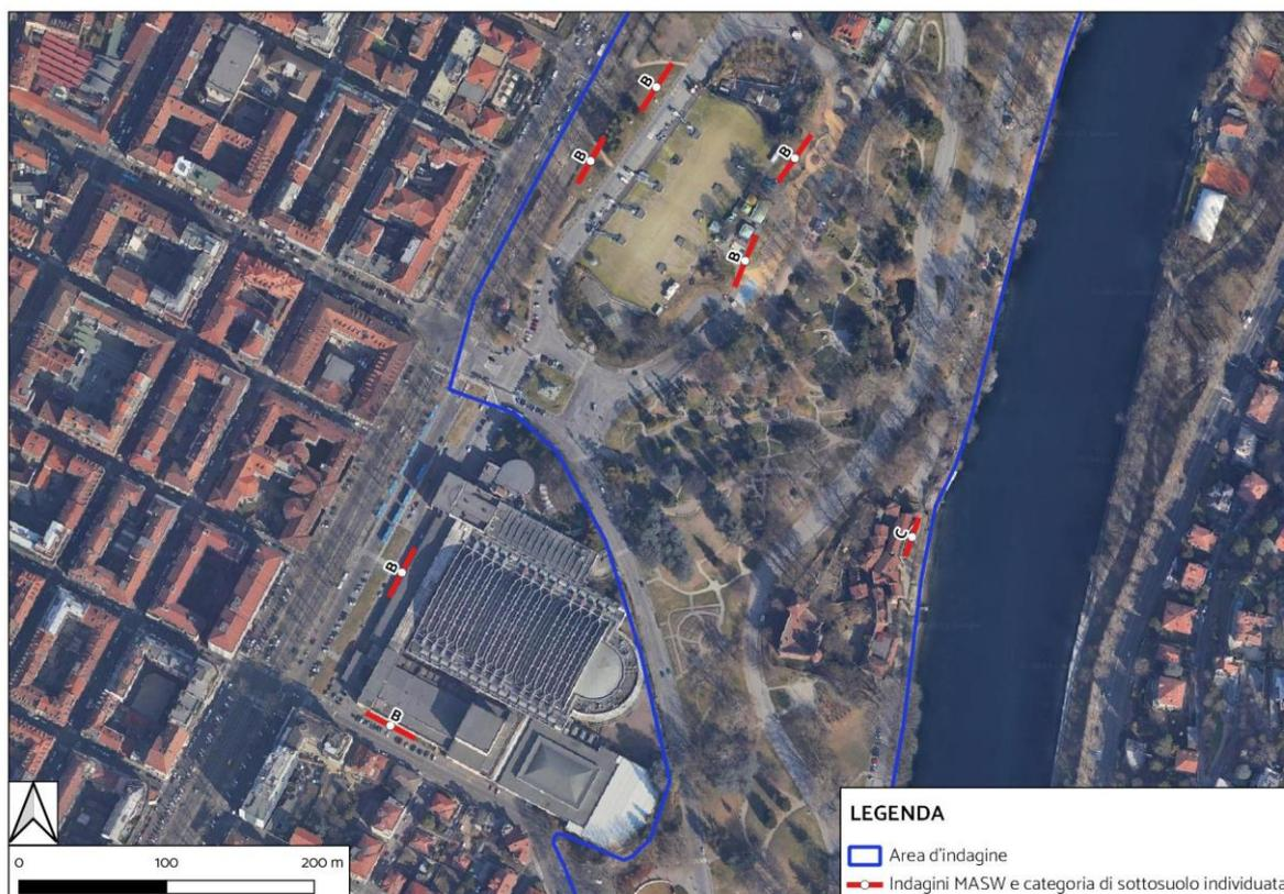
Figura 7.8: linee sismiche MASW e relativa classe di suolo individuata
