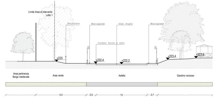
SEZIONE Q-Q' - STATO DI PROGETTO - VIALE VIRGILIO
