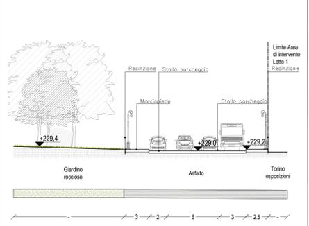
SEZIONE F-F' - STATO DI PROGETTO - VIALE BOIARDO
