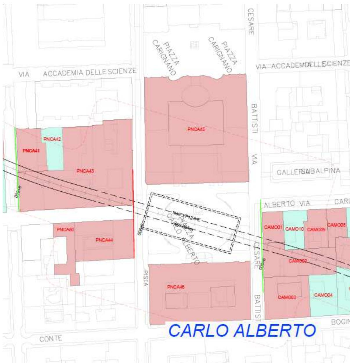
Figura 16. Stralci planimetrici riportante gli edifici con monitoraggio di Tipo 2 (in rosa)
