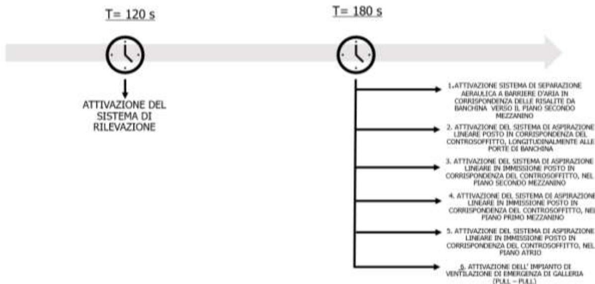
**Figura 5. Timing attivazione ventilazione impianti e sistemi**
