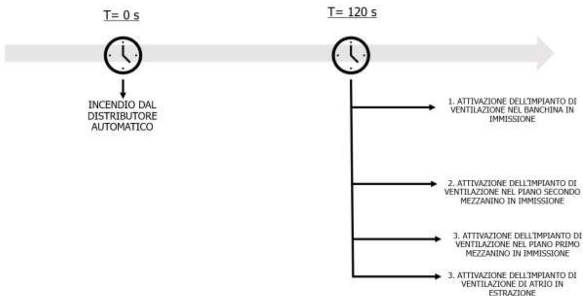
**Figura 11 – Timing Attivazione ventilazione - Impianti e Sistemi**
