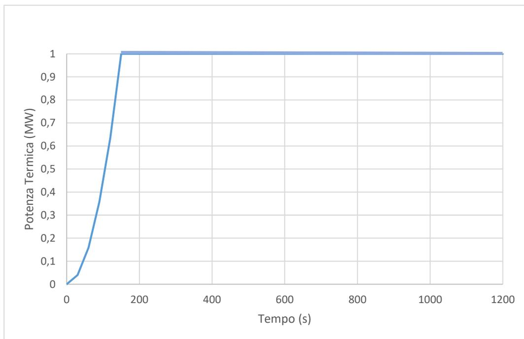
**Figura 8 – Curva di incendio distributore automatico**
