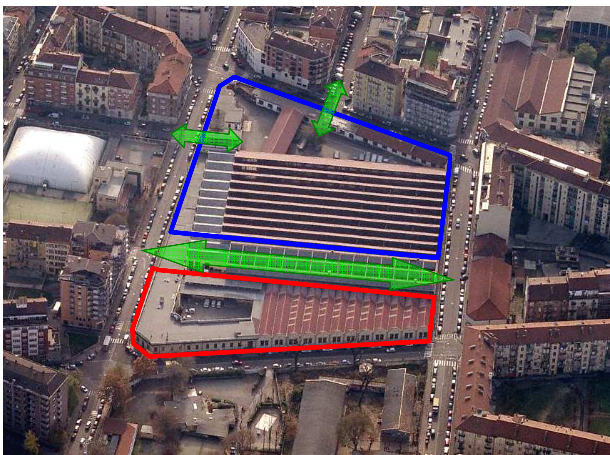
Schema illustrativo dell'idea progettuale: in rosso le parti da mantenere e valorizzare, in blu le parti da demolire e ricostruire, in verde i principali collegamenti pubblici
