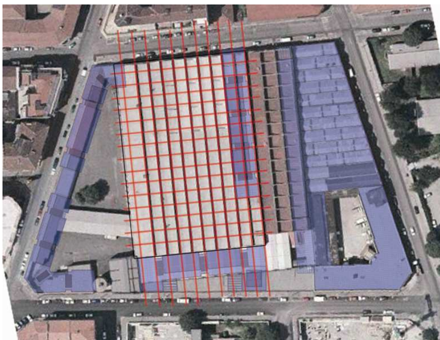
Illustrazione delle regole geometriche ispirate alla maglia strutturale del vecchio impianto industriale; (sovrapposizione della planimetria di progetto su ripresa aerea dello stato di fatto).
