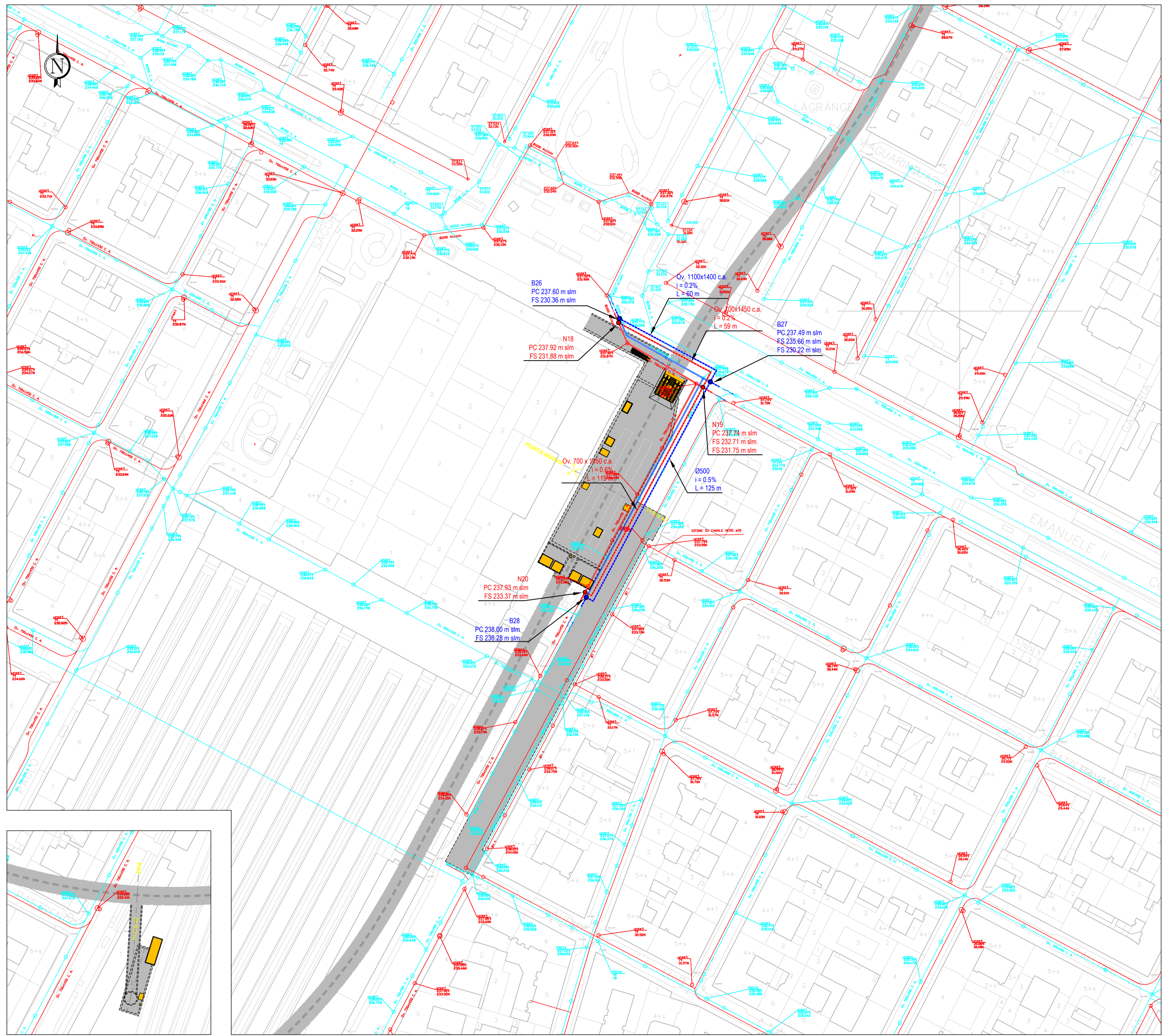
PLANIMETRIA DELLE INTERFERENZE CON LA RETE ACQUE BIANCHE E NERE E LORO RISOLUZIONE Base carta: CARTA TECNICA DELLA CITTA' DI TORINO
