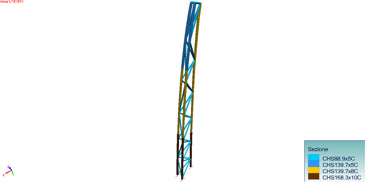
Figura 129:Modello FEM Palo
