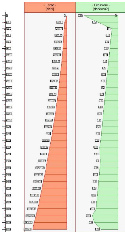
Forze (totali) e Pressioni lungo il fusto, per il Caso 4 ( FREQ. [ Frequente ] - SLE frequente )
