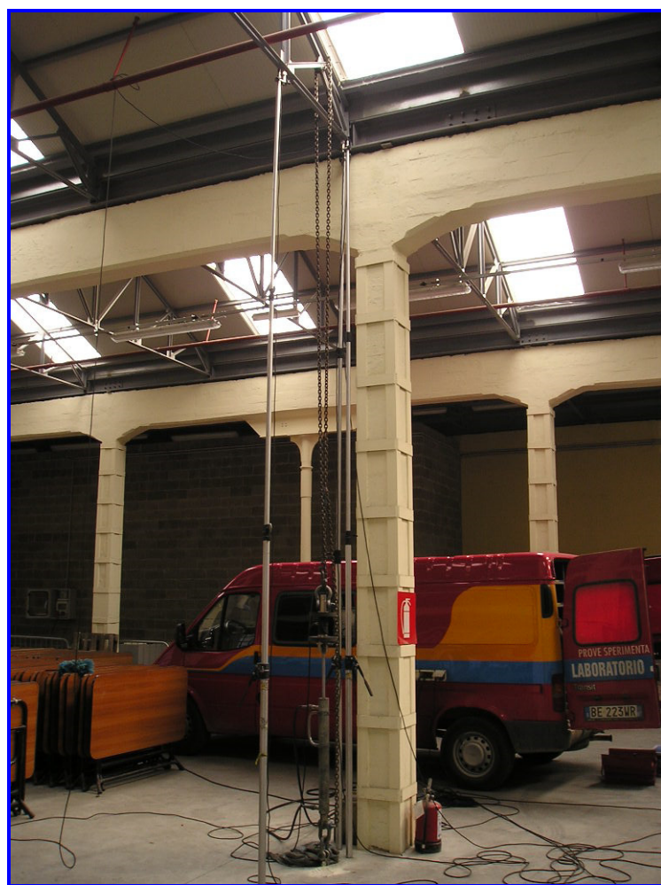
Vista delle aste telescopiche su cui sono montati i sensori differenziali
