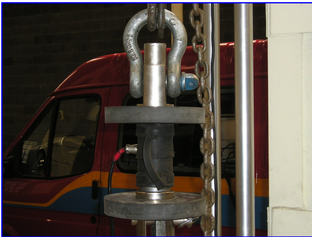
La cella di carico installata sul pistone oleodinamico
