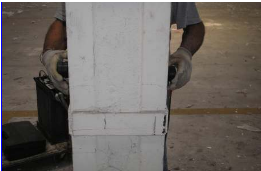
La posizione delle sonde su un pilastro
