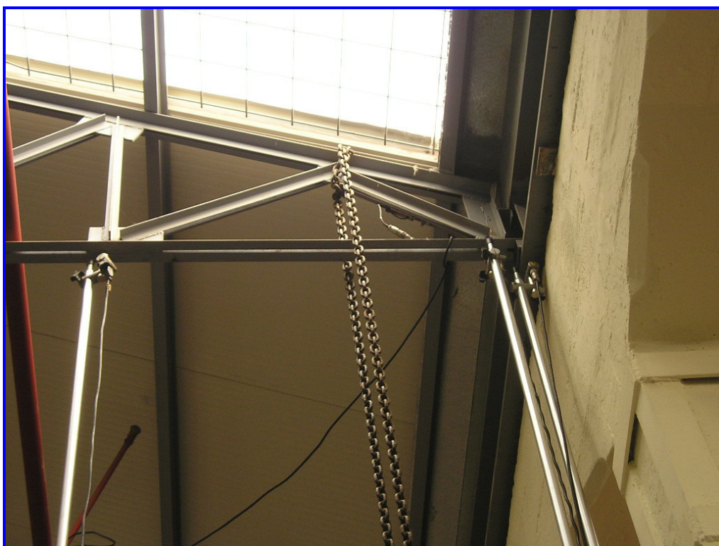
Il punto d'applicazione del carico ed i sensori per la misura delle frecce
