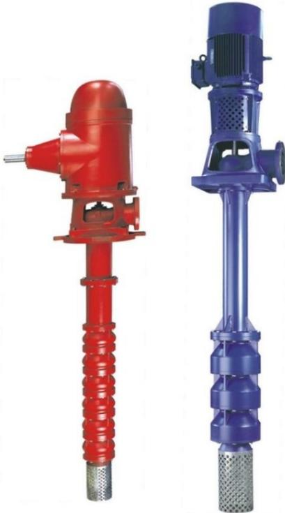
Pompe principali centrifughe multigiranti ad asse verticale con corpo in ghisa, girante in ghisa, albero in acciaio C40, tenuta meccanica in Sic/Carbone. Trasmissione meccanica pompa motore realizzato con giunto elastico spaziatore come da UNI EN 12845 par. 10.1
