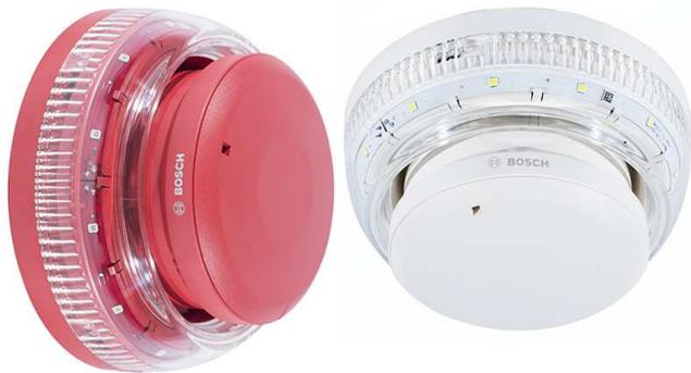
AVENAR all-in-one 4000 è una soluzione a punto singolo realizzata in Germania per le applicazioni in cui è necessario sia la segnalazione di allarme visivo che la segnalazione di allarme acustico. Il dispositivo non necessita di alimentazione esterna aggiuntiva. In modalità standby è alimentato dal loop e in modalità di allarme l'alimentazione aggiuntiva viene fornita dalla batteria integrata. Il concetto della batteria garantisce un'elevata quantità di dispositivi per loop.
