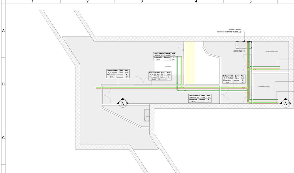
1 Impianto di Rivelazione Incendi e Controllo Accessi - Piano primo interrato (livello -1) - Layout vie cavi
