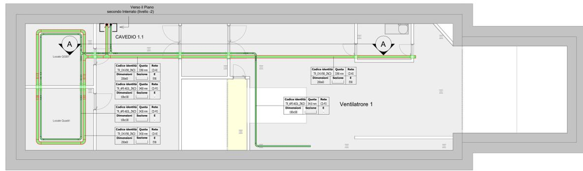
1 Impianto di Rivelazione Incendi e Controllo Accessi - Piano primo interrato (livello -1) - Layout vie cavi
