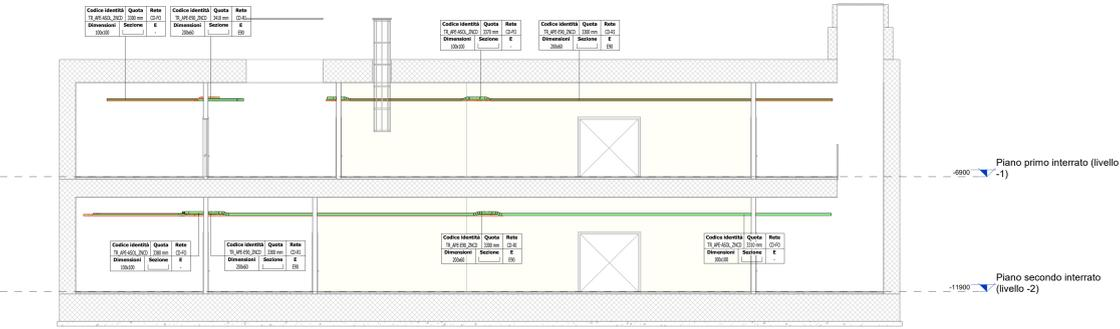
A Impianto di Rivelazione Incendi e Controllo Accessi - Sezione A-A
