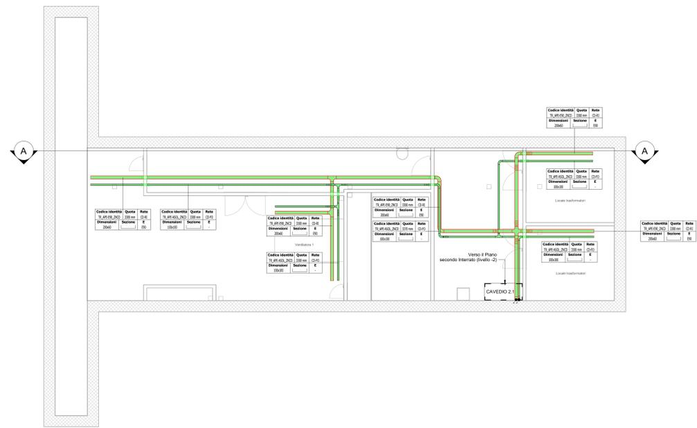
1 Impianto di Rivelazione Incendi e Controllo Accessi - Piano primo interrato (livello -1) - Layout vie cavi
