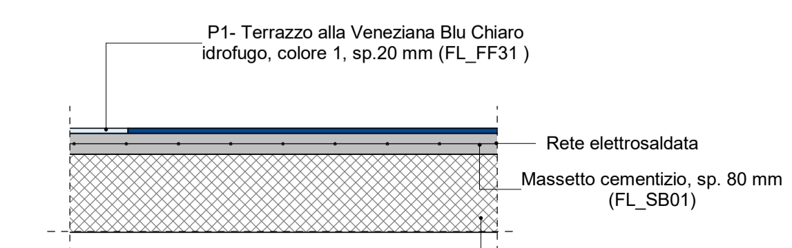
17 Pavimentazione Terrazzo alla Veneziana (banchina)
