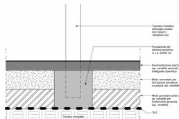
DETTAGLIO 06 - FISSAGGIO PENSILINA A TERRA
