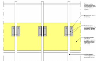
DETTAGLIO 05 - PROSPETTO NORD FISSAGGIO PENSILINA SU COPERTURA
