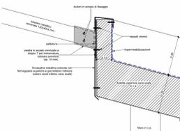
DETTAGLIO 04 - SEZIONE FISSAGGIO PENSILINA SU COPERTURA
