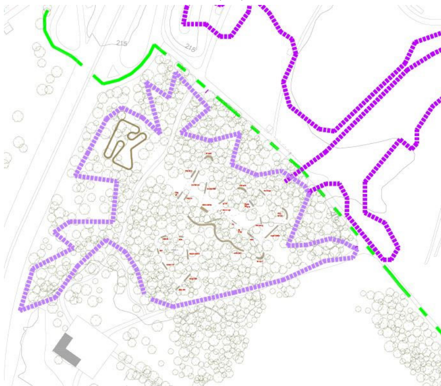
tracciato per il ciclocross – la linea verde segna il confine dell'area di intervento
