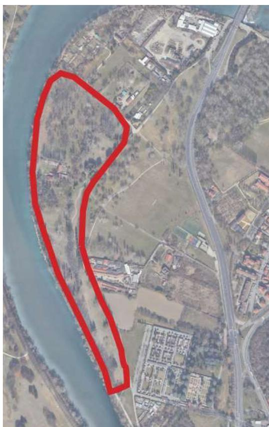
Trattasi dell'area più ad alta naturalità del parco. Un rilevato arginale è presente lungo tutta la sponda, con la parte inferiore in calcestruzzo sormontata da terreno; la quota arginale posta intorno ai 213 m s.l.m. è sopraelevata di circa 3m rispetto al piano campagna per la buona parte della sua estensione.
