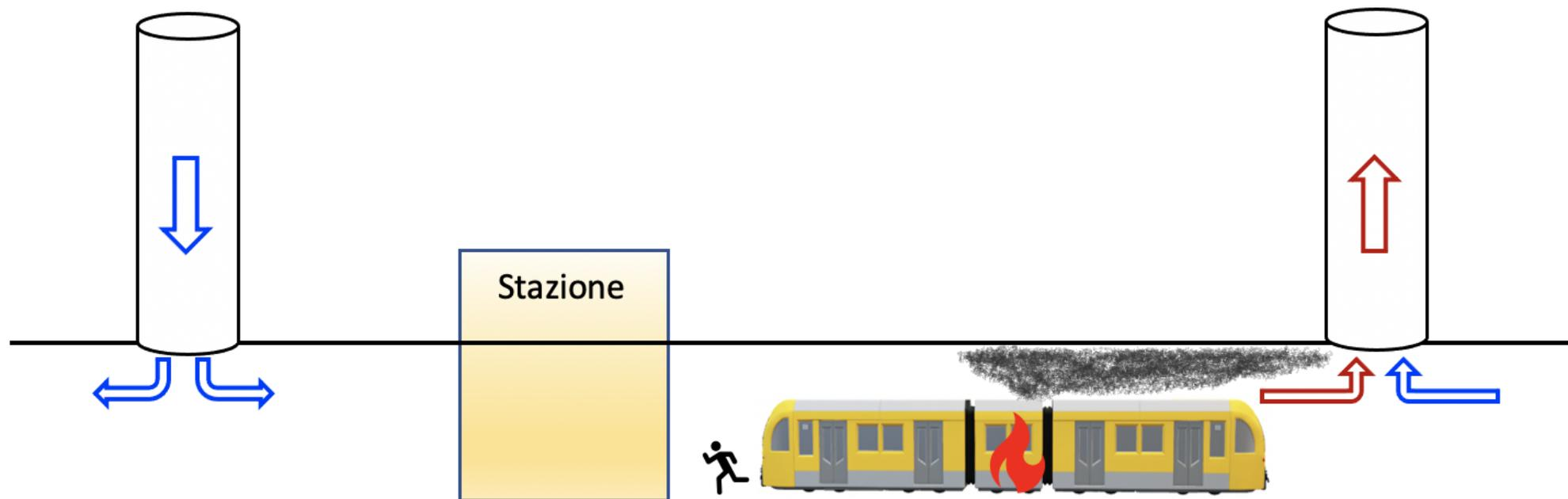
Figura 3 Schema Push Pull con incendio a sinistra del pozzo più vicino.
