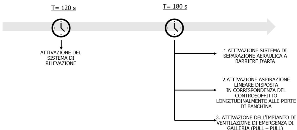
**Figura 2 - Timing attivazione ventilazione Impianti e Sistemi (SCENARIO 1)**
