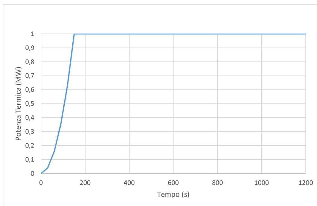
**Figura 3 – Curva di incendio distributore automatico**
