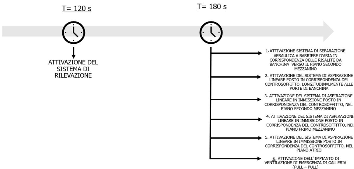
**Figura 4. Timing attivazione ventilazione impianti e sistemi**
