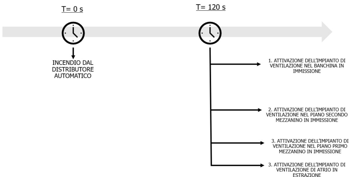
**Figura 11 – Timing Attivazione ventilazione - Impianti e Sistemi**
