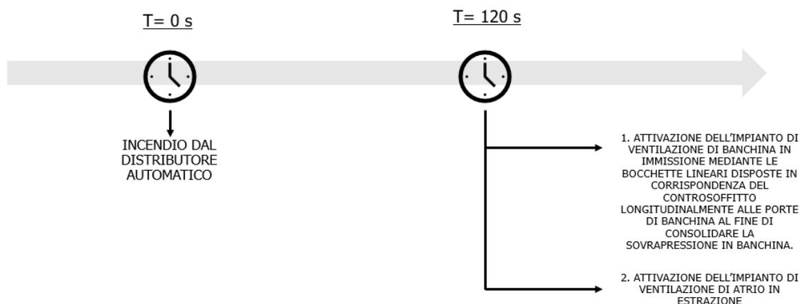
**Figura 4 – Timing Attivazione ventilazione Impianti e Sistemi (SCENARIO 3)**
