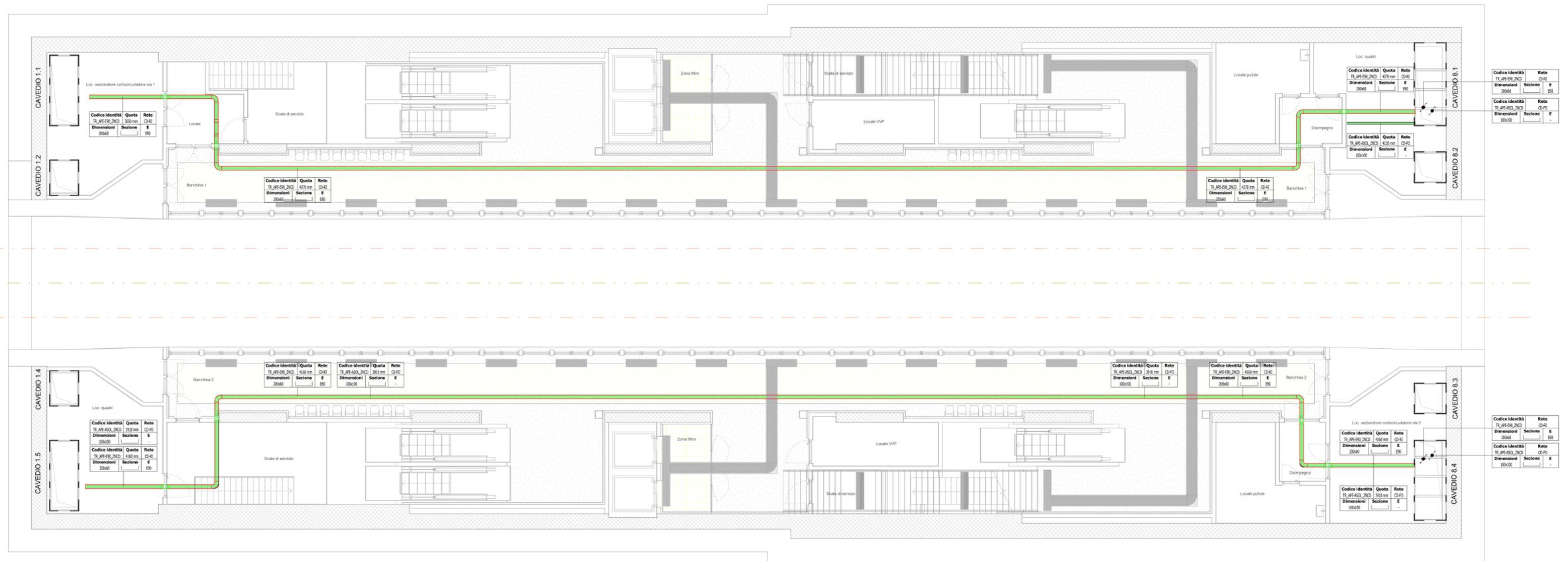
1 Impianto di Rivelazione Incendi e Controllo Accessi - Vie Cavi Pianta Piano banchina
