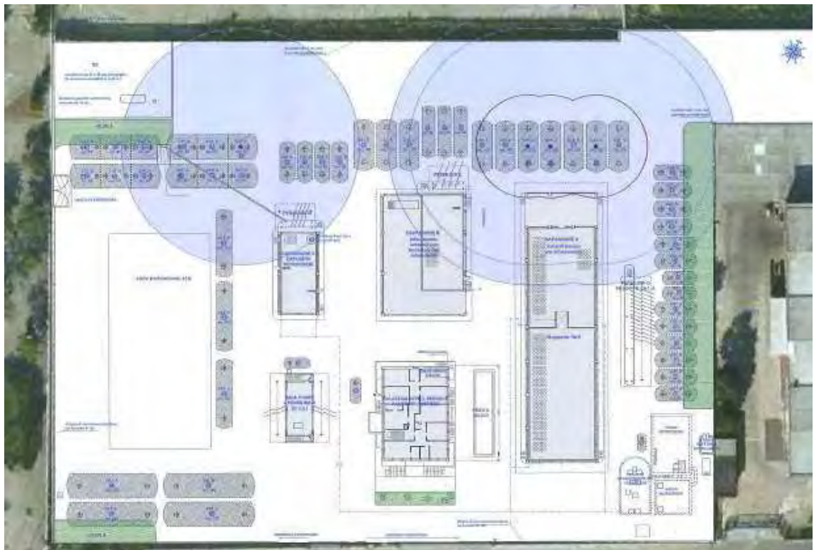
Figura n.5 – Scenari incidentali ed aree di danno (irraggiamento “Flash fire”)
