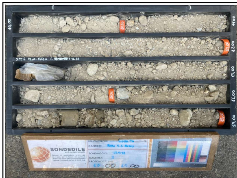
Figura 8. Carote alle profondità 10-15m nel sondaggio SP-D32, rappresentative delle ghiaie e sabbie corrispondenti all'Unità 2 nel Profilo geotecnico.
