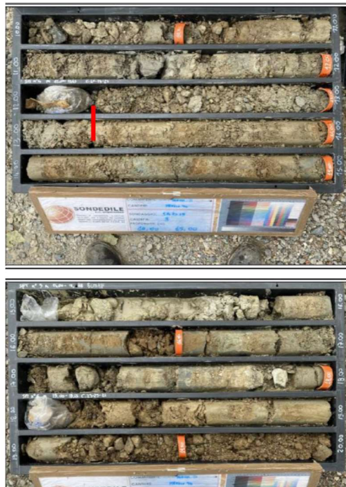
Figura 6. Sondaggio SP-D15 mostrante contatto a -13,2m (linea rossa) tra ghiaie sabbiose ed alternanze di ghiaie e sabbie-limose addensate in livelli fino a 50-70 cm di spessore.
