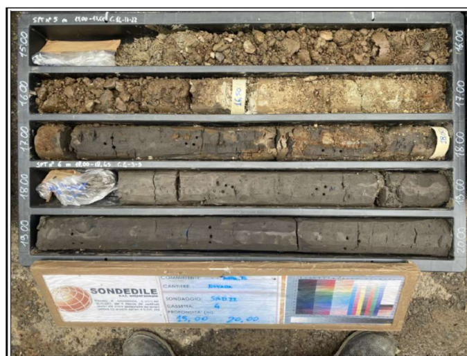
Figura 7. Dettaglio del sondaggio SP-D22 in cui a 17 metri sono presenti livelli di argilla grigio-scura intervallati a sottili ghiaie.
