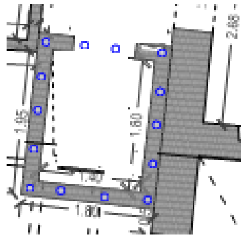
Fig. 5 – Micropali per fossa ascensore
