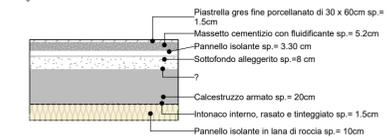
S6 SOLAIO PIANO DI COPERTURA ALLOGGI \_ 53 CM
