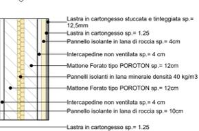
M3 MURATURA DI TAMPONAMENTO IN BLOCCHI DI LATERIZIO CON CAPPOTTO ESTERNO \_ 49 CM
