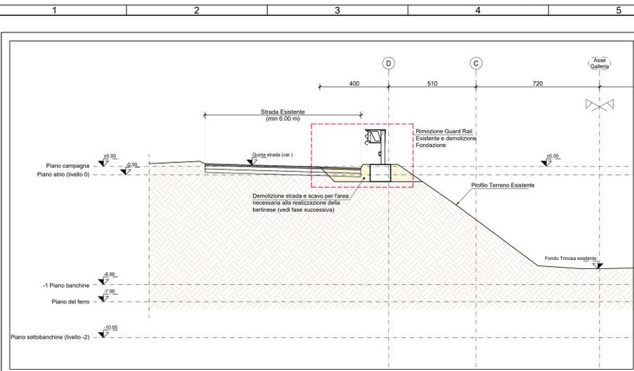
**FASE 1 - DEMOLIZIONE GUARD RAIL ESISTENTE**
