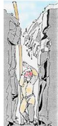
Gli scavi devono essere realizzati ed armati come richiesto dalla natura del terreno, dall'inclinazione delle pareti e dalle altre circostanze influenti sulla stabilità ed in modo da impedire slittamenti, frane, crolli e da resistere a spinte pericolose, causate anche da piogge, infiltrazioni, cicli di gelo e disgelo.
