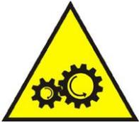
**Situazioni di pericolo:** Presenza di macchine con parti mobili (escavatori, gru, sollevatori, ecc.) o automezzi e equipaggiamenti in genere in posizione instabile.
