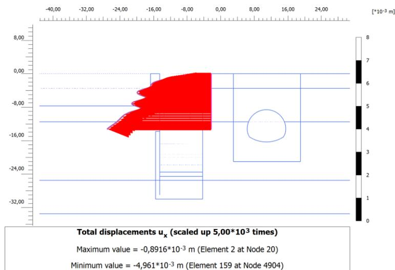
Figura 31. Spostamenti orizzontali – Micropali L=13m - Accesso speciale
