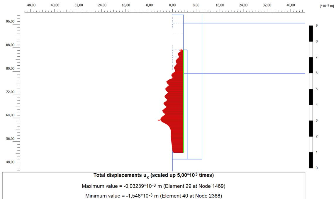
Figura 11. Diagramma degli spostamenti orizzontali della paratia
