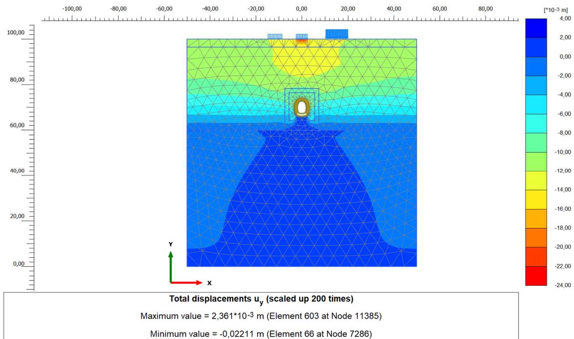
Figura 24. Campo dei cedimenti fase di falda a lungo termine
