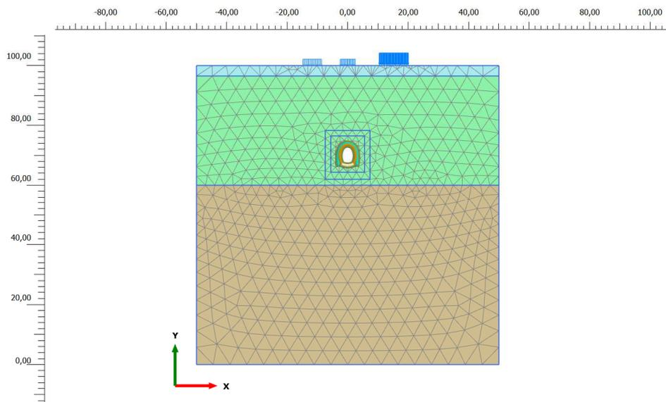
**Figura 5. Modello di calcolo e relativa mesh del tronchino di collegamento del pozzo Mole-Giardini Reali "PMO"**
