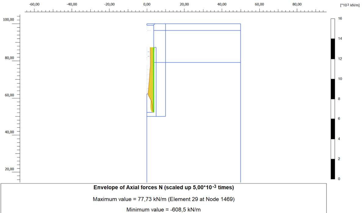
Figura 10. Inviluppo dello sforzo normale – SLE
