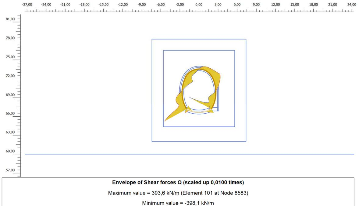
Figura 16. Inviluppo diagramma del taglio – rivestimento definitivo: Fase di falda a lungo termine
