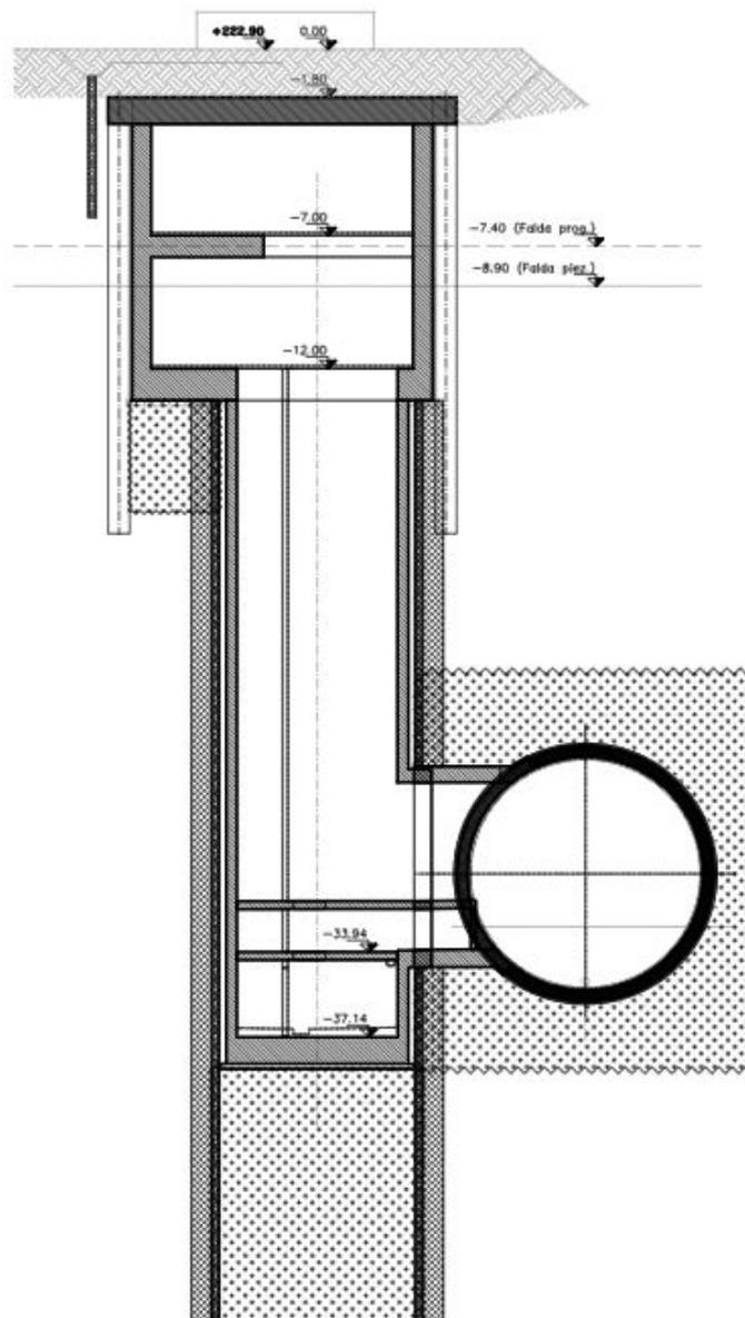
Figura 2. Sezione trasversale del pozzo di ventilazione Mole-Giardini Reali (PMO)
