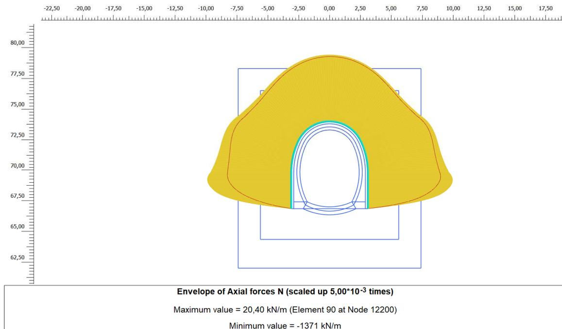
Figura 12. Involuppo diagramma dello sforzo normale - centine
