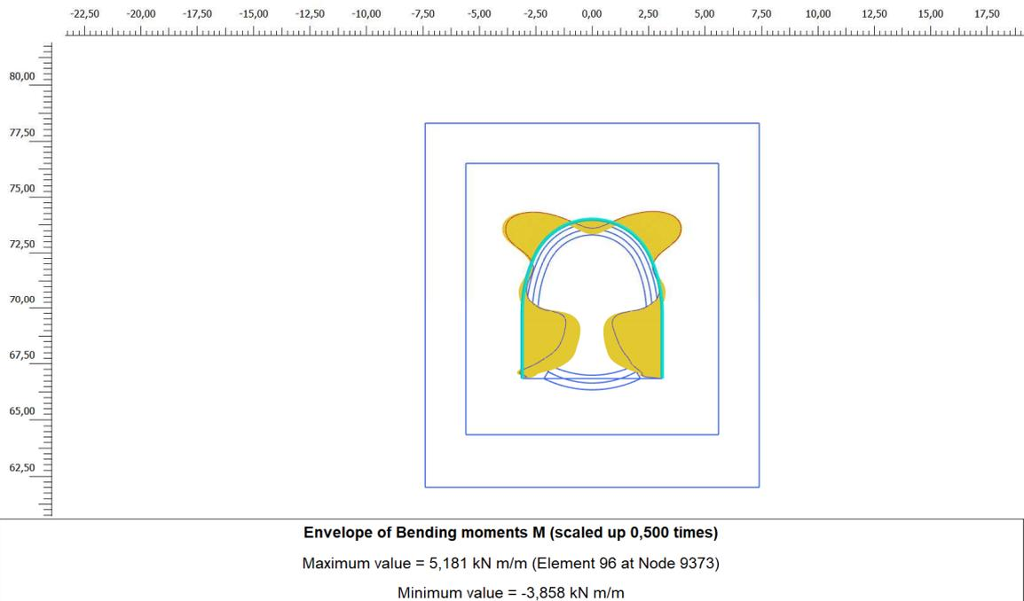
Figura 13. Inviluppo diagramma del momento flettente - centine
