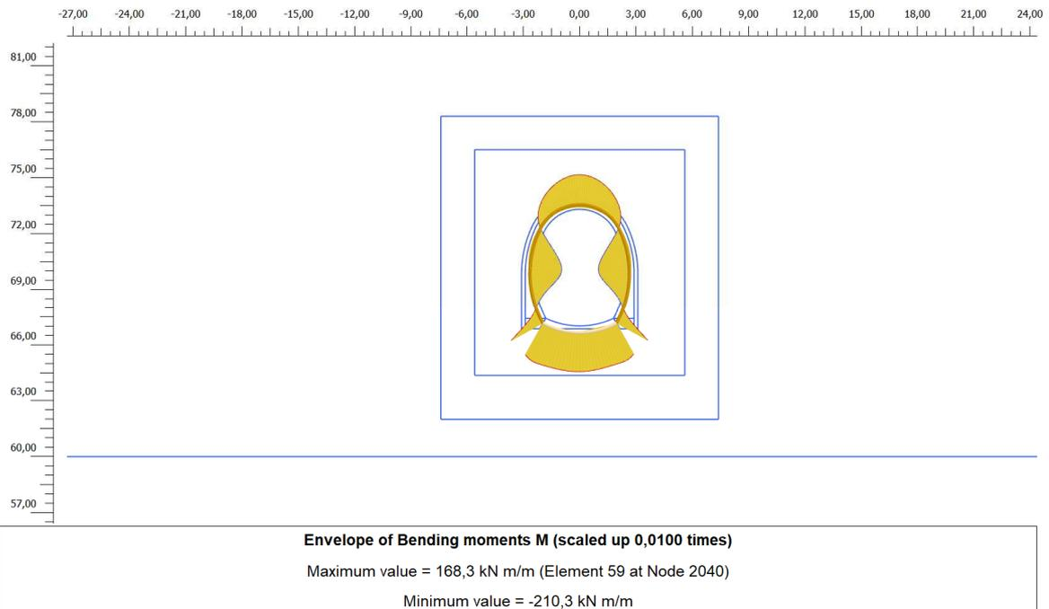
**Figura 17. Inviluppo diagramma del momento flettente – Rivestimento definitivo: fase di falda a lungo termine**
