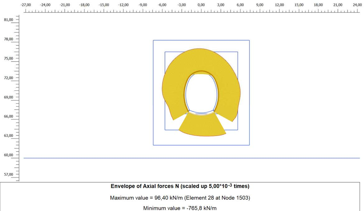
Figura 18. Involuppo diagramma dello sforzo normale – rivestimento definitivo: Azione sismica (+)
