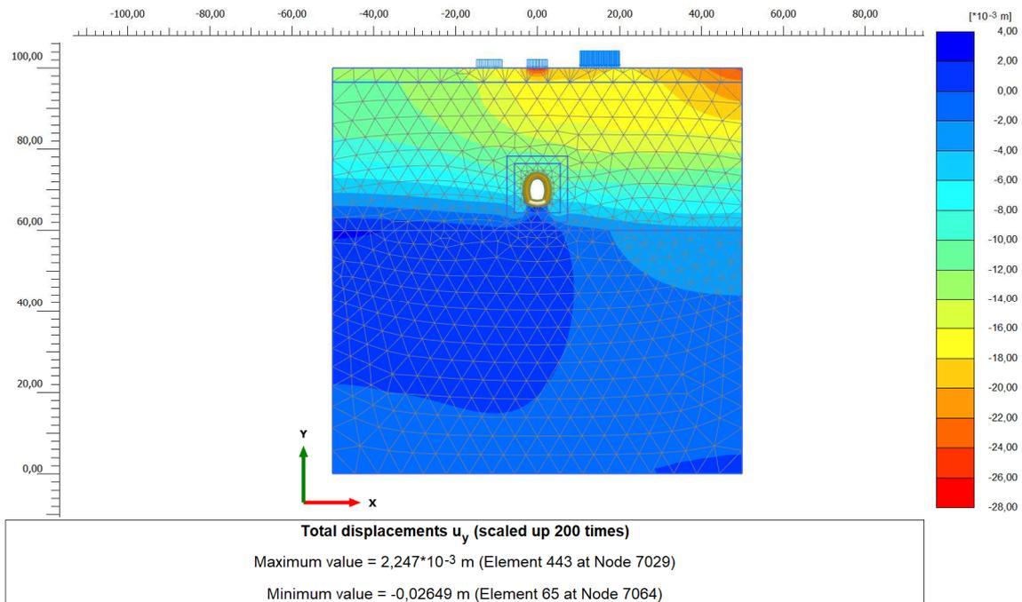
Figura 25. Campo dei cedimenti fase azione sismica (+)
