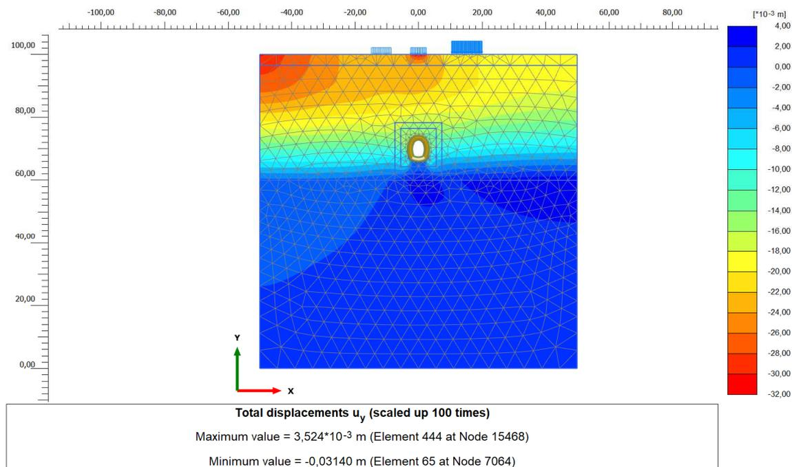
Figura 26. Campo dei cedimenti fase azione sismica (-)
