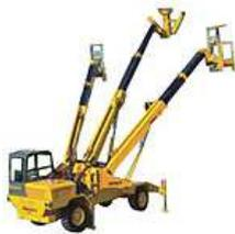
Macchina dotata di carro di base proprio sul quale sono installati un braccio telescopico dotato di pinza idraulica per il sollevamento, posizionamento e sostegno della cantina e ponti sviluppabili con cestello, indipendenti dal braccio portapinza, per le operazioni di finitura del montaggio. Tale mezzo è dotato di un lampeggiante arancio/giallo sul tetto della cabina e di un segnalatore acustico di retromarcia.
