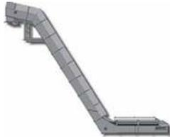
I nastri trasportatori sono composti da una struttura portante tubolare o di lamiera stampata, testata motrice, testata di rinvio con dispositivo tenditore, gruppo rulli e tappeto di gomma. I gruppi porta-rulli hanno diverse versioni a seconda che debbano alloggiare rulli in sistemazione piana, accoppiati a V o a conca.
