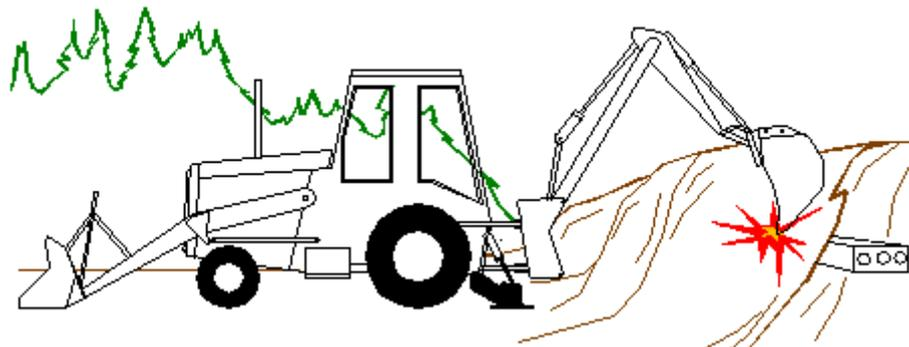
Figura 1 - Contatto con linee elettriche interrato
