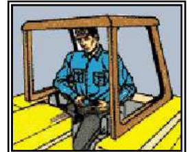
L'operatore è quindi protetto dalla struttura speciale della cabina contro il pericolo di schiacciamento, dovuto al ribaltamento del mezzo e contro la caduta di materiale. Nel caso del ribaltamento è necessario però che l'operatore sia allacciato con le cinture di sicurezza. In tal modo non verrà proiettato all'esterno e non correrà il rischio di rimanere schiacciato dal mezzo.
