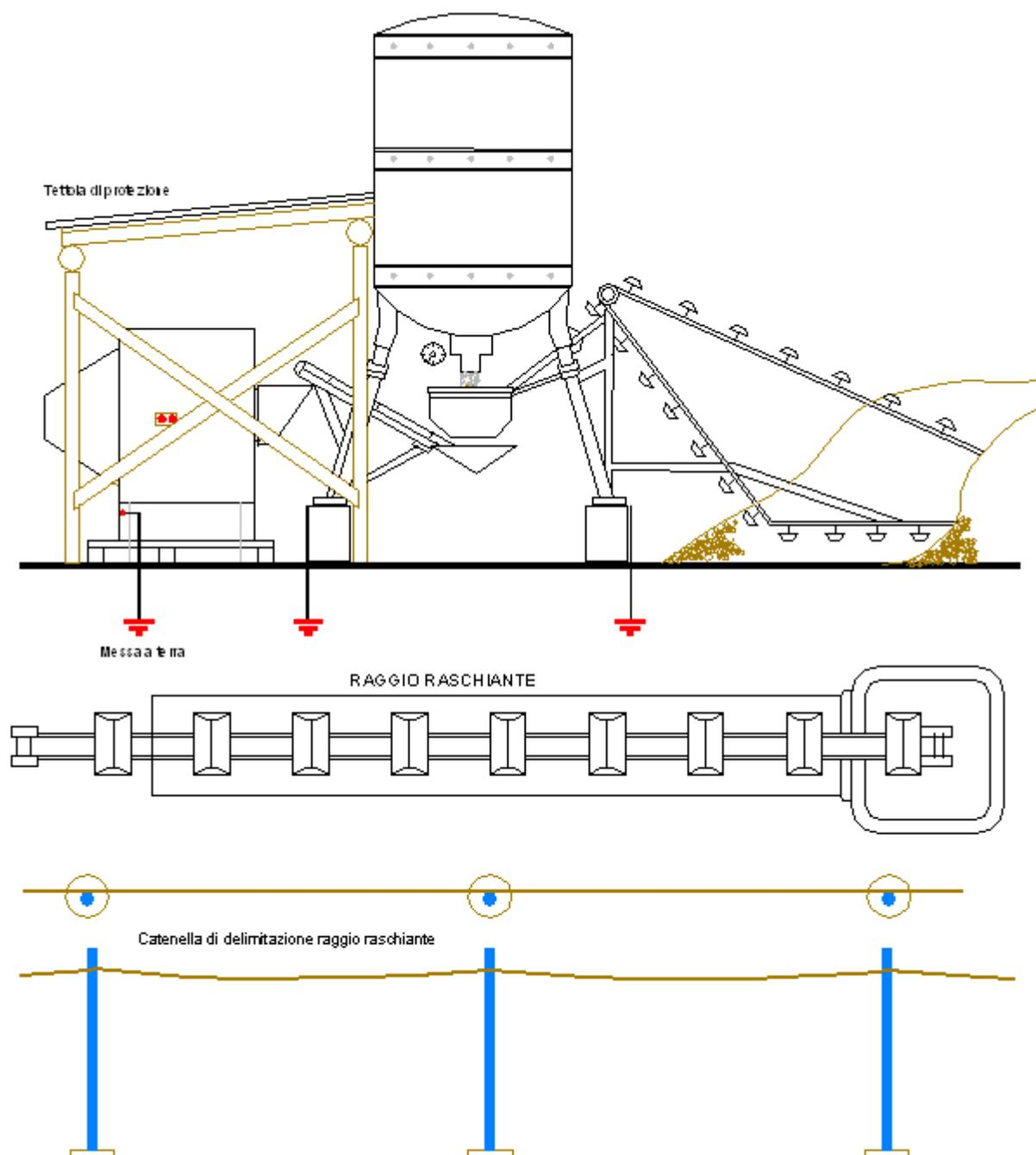
Figura 1 - Protezioni area di lavoro centrale di betonaggio
