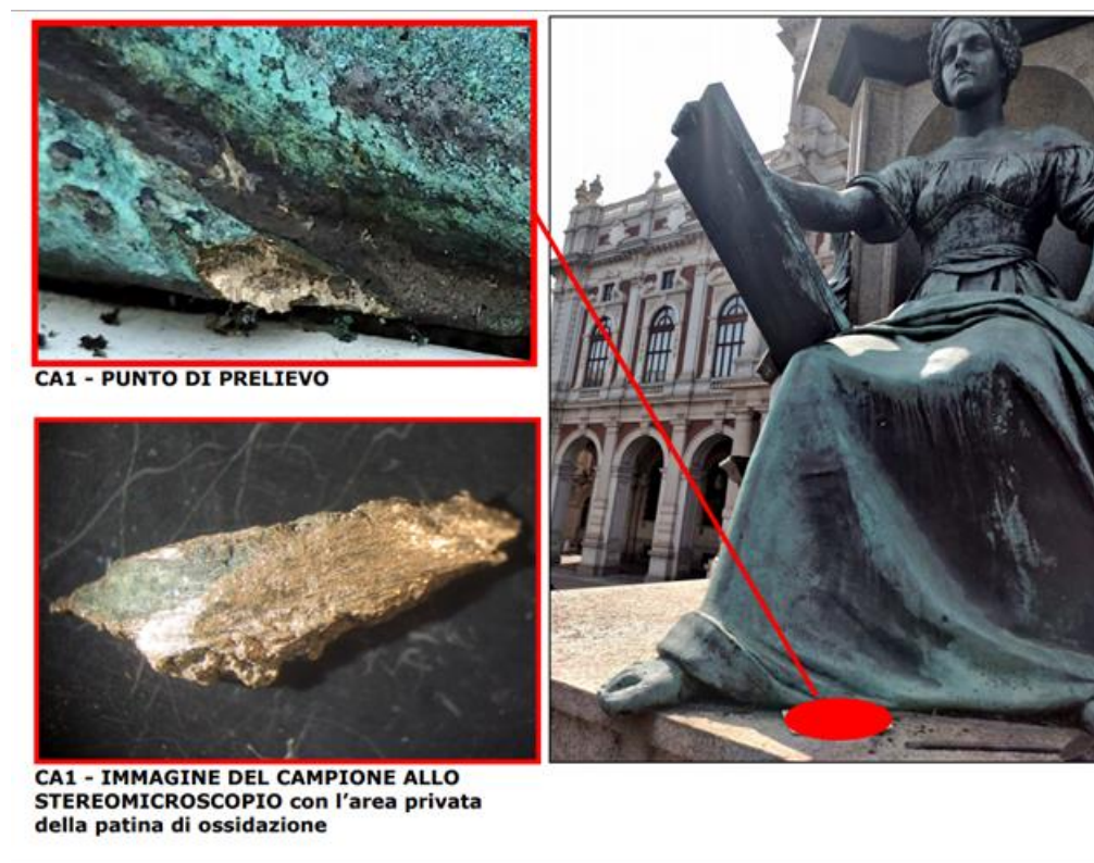
Figura 124. Punto di prelievo del campione bronzeo CA1 per la spettrofotometria
