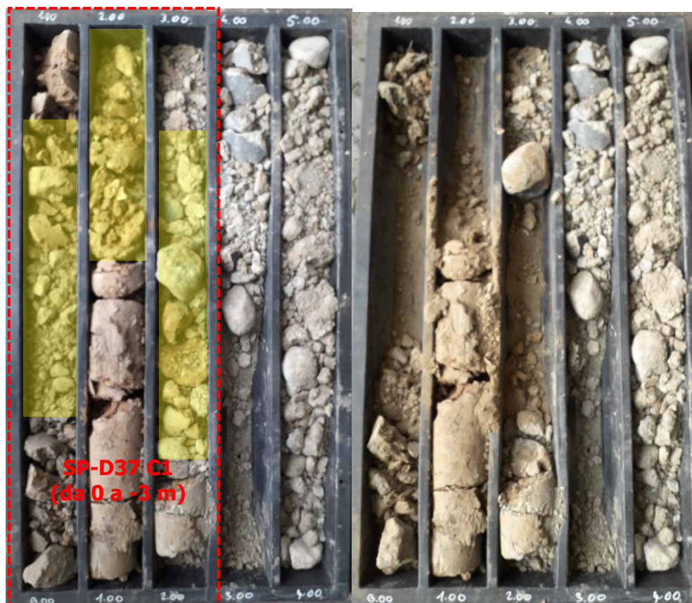
Figura 31 - Fotografia della cassetta catalogatrice C1 0-5 m del sondaggio geotecnico sigla SP-D37 scattata preventivamente (a sx) e successivamente (a dx) al prelievo del campione SP-D37 C1 (da 0 a 3 m)
