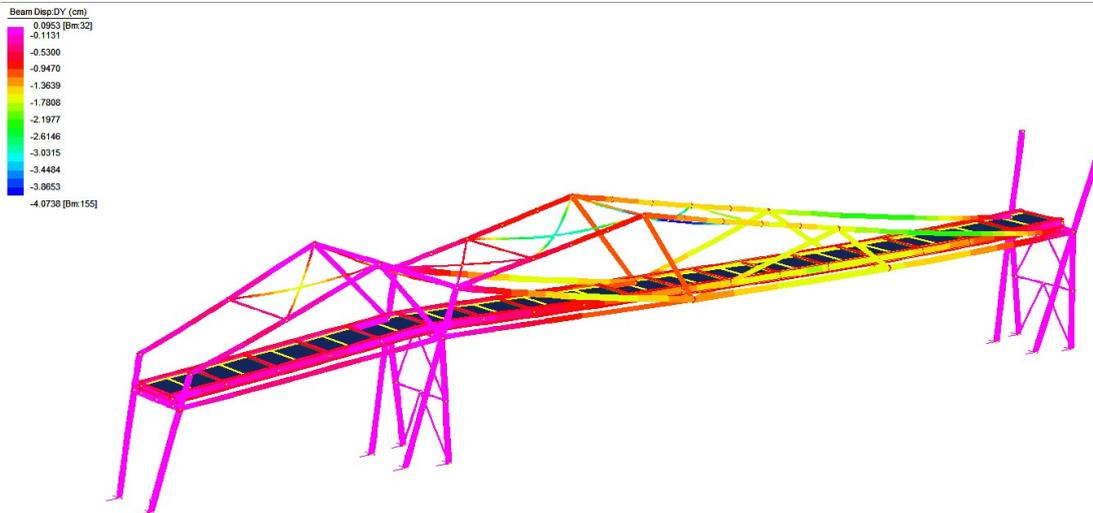
**Spostamenti verticali degli elementi strutturali per carico da peso proprio**
