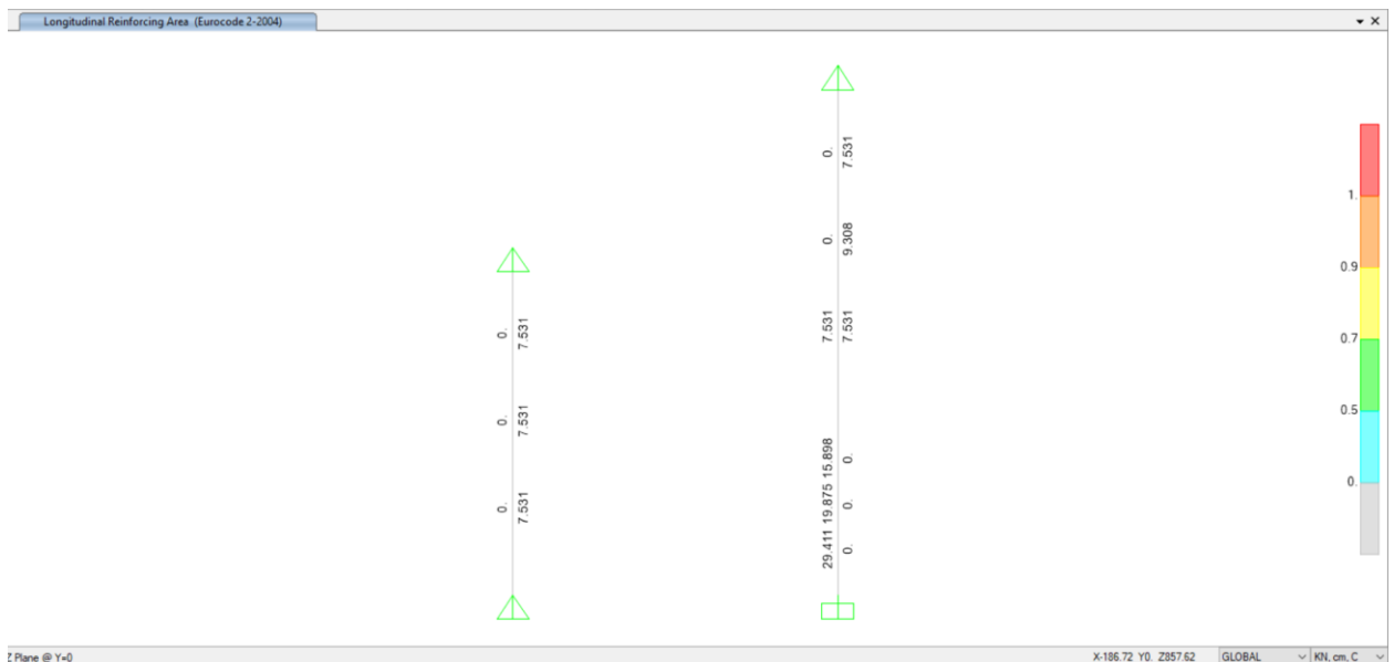
Figura 55. Rinforzo longitudinale in cm 2 /m
