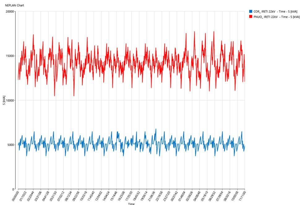
**Figura 22 - Potenza apparente assorbita dalle due connessioni alla rete pubblica nello scenario B1.**
