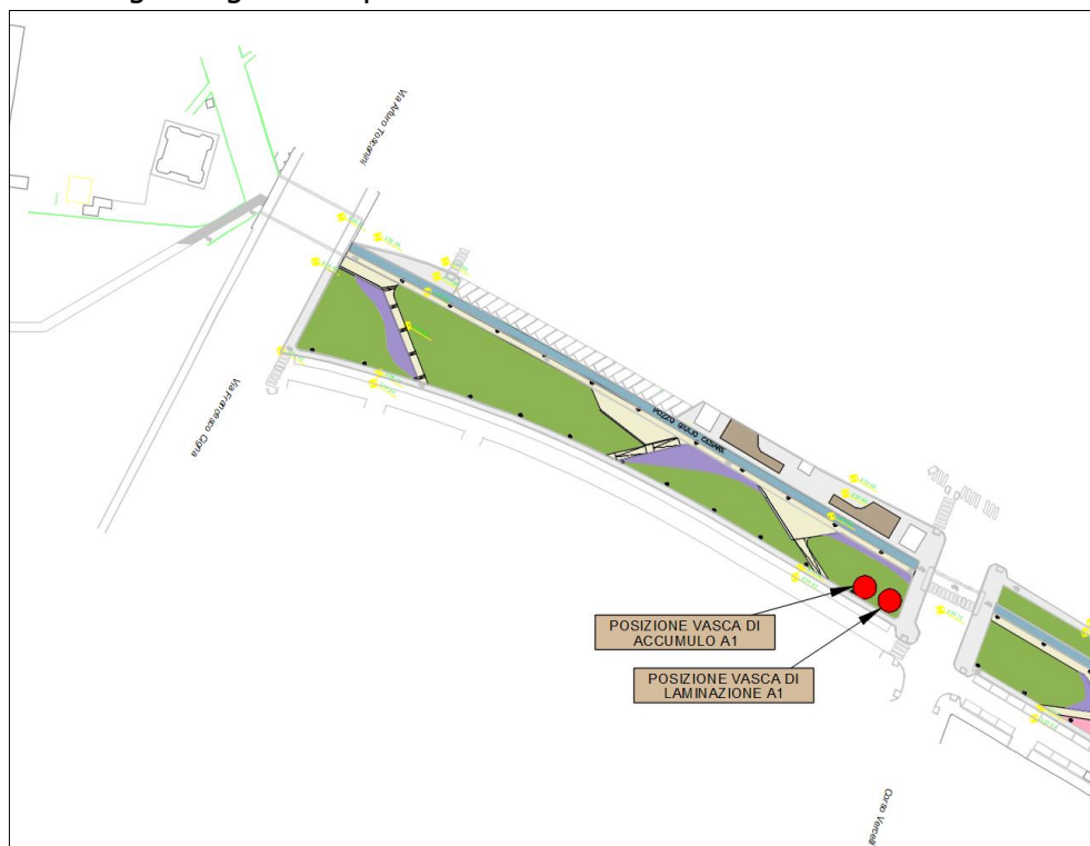
Figura 78 - Posizione indicativa vasche sistema raccolta e smaltimento.
