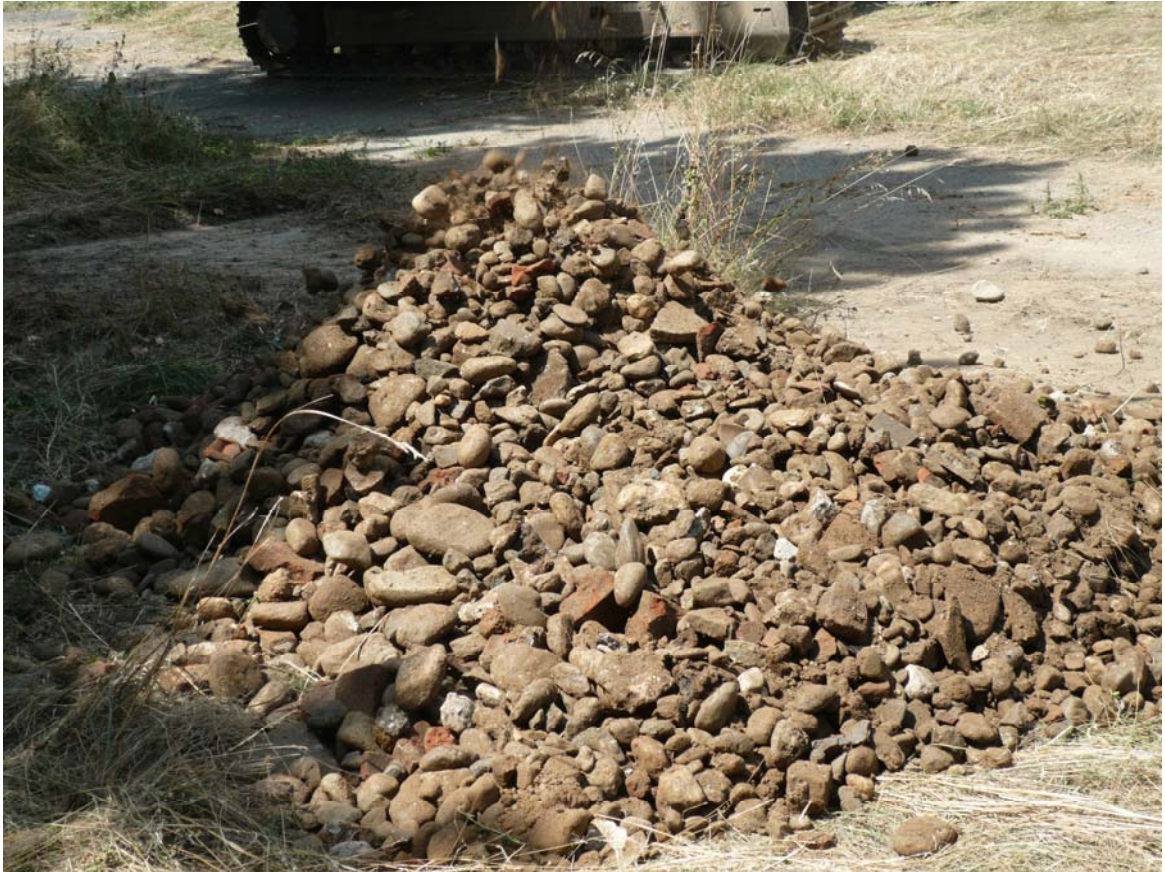
Test di vagliatura lato Sud – materiale grossolano
