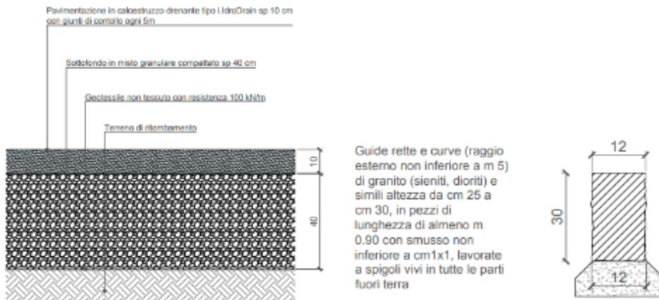
Figura 8. Sezione tipo pavimentazione cls drenante e cordolo
