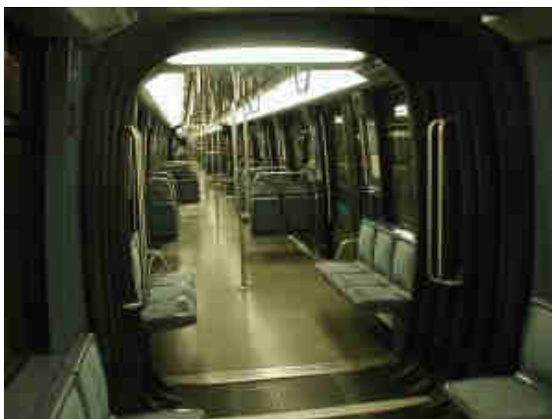
Figura 11. Veicolo ALSTOM - Vista interna intercomunicante
