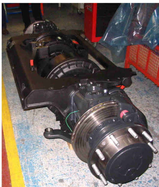
Figura 20. Veicolo SIEMENS Cityval – Asse di direzione e motore elettrico
