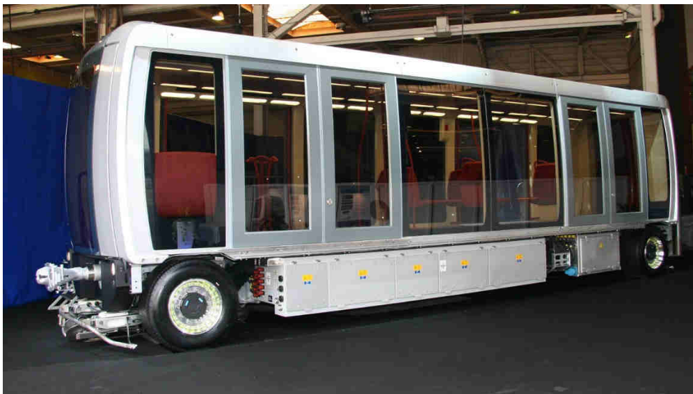
Figura 7. Veicolo Neoval – Vista laterale con accoppiatore automatico
