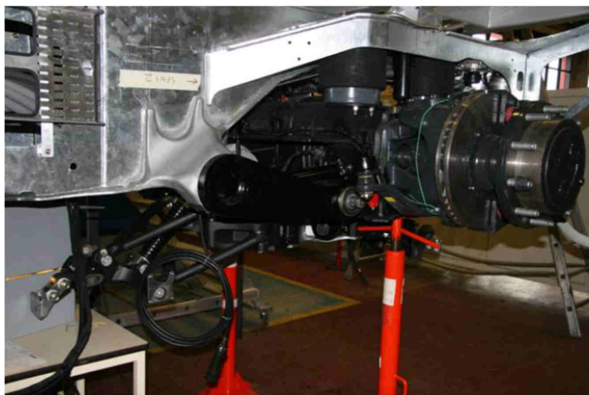
Figura 19. Veicolo SIEMENS Cityval – Asse di direzione e mozzo ruota con disco freno ventilato
