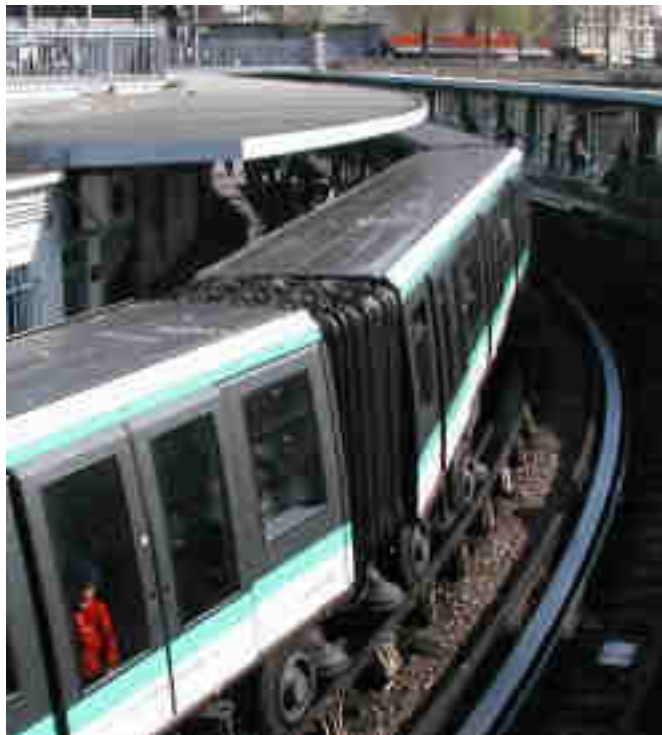
Figura 10. Veicolo ALSTOM - Vista laterale con intercomunicante
