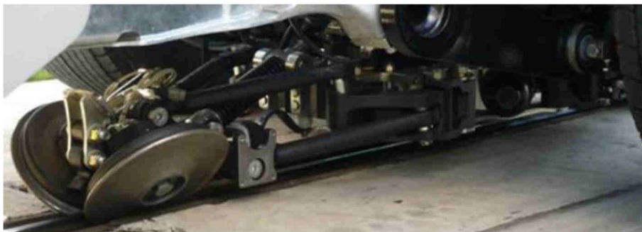
Figura 24. Veicolo SIEMENS Cityval – Sistema di guida
