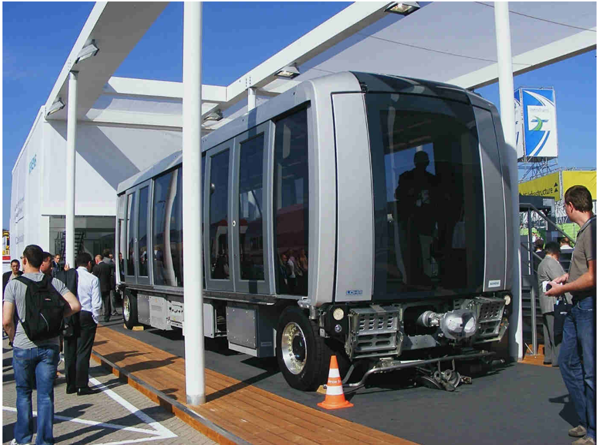
Figura 6. Veicolo Neoval – Vista frontale con accoppiatore automatico
