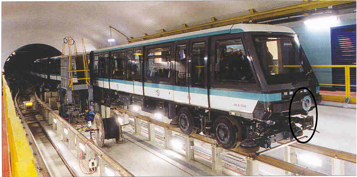
Figura 4. Veicolo ALSTOM (Metropolitana di Parigi) – Vista frontale con accoppiatore automatico
